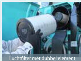
Luchtfilter met dubbel element
